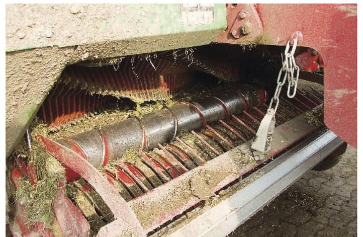
Die Beschleunigerwalze zwischen Pick-up und Förderrotor optimiert das Ladesystem für gleichmäßige Beschickung des Rotors.
