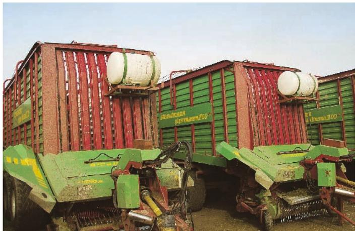
Mehrere Ladewagen sind auch mit einem Dosieraggregat ausgestattet.
